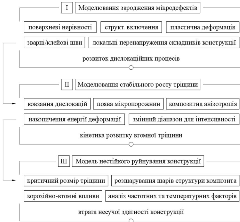
Рисунок 2 – Схема послідовності стадій розвитку втомного руйнування матеріалів авіаційних конструкцій
