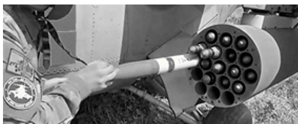
Рисунок 5. Спорядження блоку некерованого ракетного озброєння М261 некерованими авіаційними ракетами типу Hydra-70
