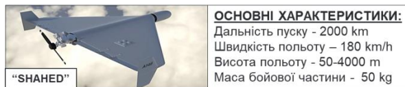
Рисунок 5. Основні характеристики безпілотного літального апарату “Shahed-136”
