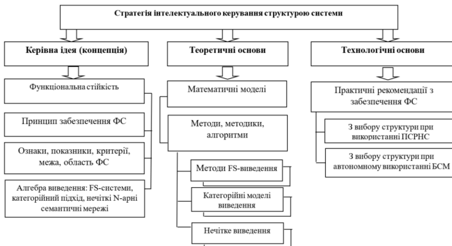
Рисунок 3. Схема стратегії інтелектуального керування гнучкою структурою комплексної системи навігації та моніторингу
