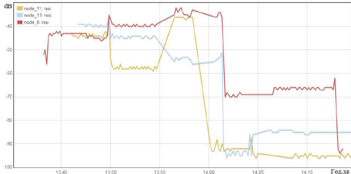
Рис. 3 Графіки зміни рівня сигналів вузлів 8, 11, 13 при реконфігурації MESH-мережі
