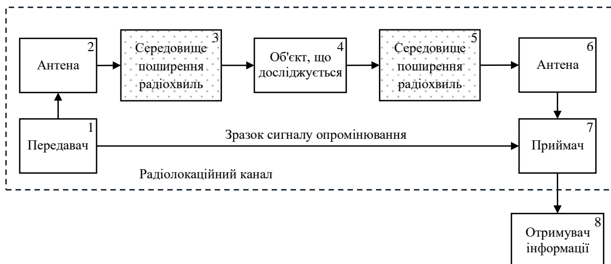
Рисунок 1. Узагальнена схема активної РТС здобування інформації
