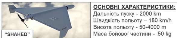
Рисунок 5. Основні характеристики безпілотного літального апарату “Shahed-136”
